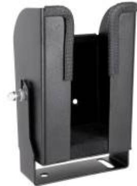
Scannerhalter, Material: 2mm Stahl, RAL 9005 Tiefschwarz Feinstruktur gepulvert, inkl. schwenkbarem Montagebügel, Schaumstoffeinlage zum Schutz des Gerätes vor Beschädigung und Vibration
