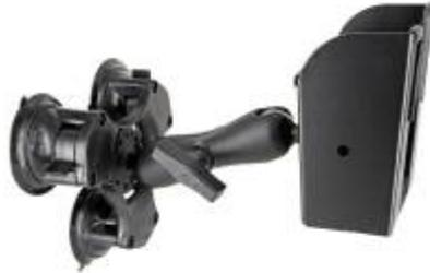
Halterung für Flurförderfahrzeuge, Material: 2mm Stahl, RAL 9005 Tiefschwarz Feinstruktur gepulvert, Schaumstoffeinlage zum Schutz des Gerätes und zur Verminderung von Vibrationen, Bohrungen auf der Vorderseite der Scannerhalterung für den Einsatz mit RAM Mounts Basisplatte (nicht im Lieferumfang enthalten), inkl. Schrauben zur Befestigung der RAM Mounts Basisplatte
